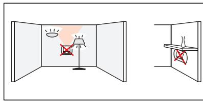
Placer le détecteur de manière à ne pas l'exposer à la lumière artificielle déjà diffusée dans le local d'installation.
