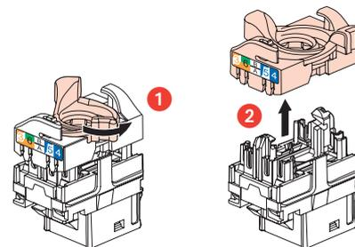
Ce système permet d'épanouir facilement les paires avant montage sur le connecteur.
