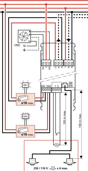
Les deux voies sont synchronisées, cela permet de placer les luminaires en quinconce avec une phase d'alimentation des ballasts sur chaque voie.
