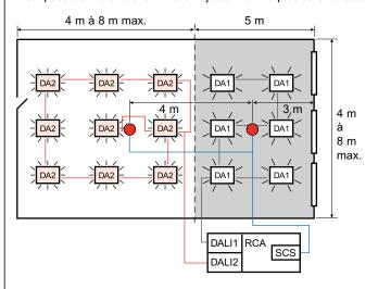
Le(s) détecteur(s) BUS est (sont) relié(s) au contôleur. Dans ces modes, le contrôleur applique une différence de variation de + 30% (mode 1), + 50% (mode 2), + 80% (mode 3) entre la voie DA1 (côté fenêtre) et la voie DA2 (côté couloir).
