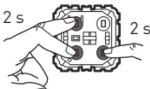
Permet un réallumage systématique au niveau d'éclairement avant la dernière extinction (retour en mode usine)
