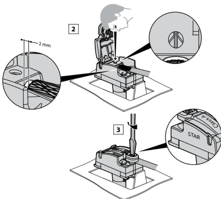
Utiliser du câble coaxial  $\varnothing$  5,5 à 7 mm
