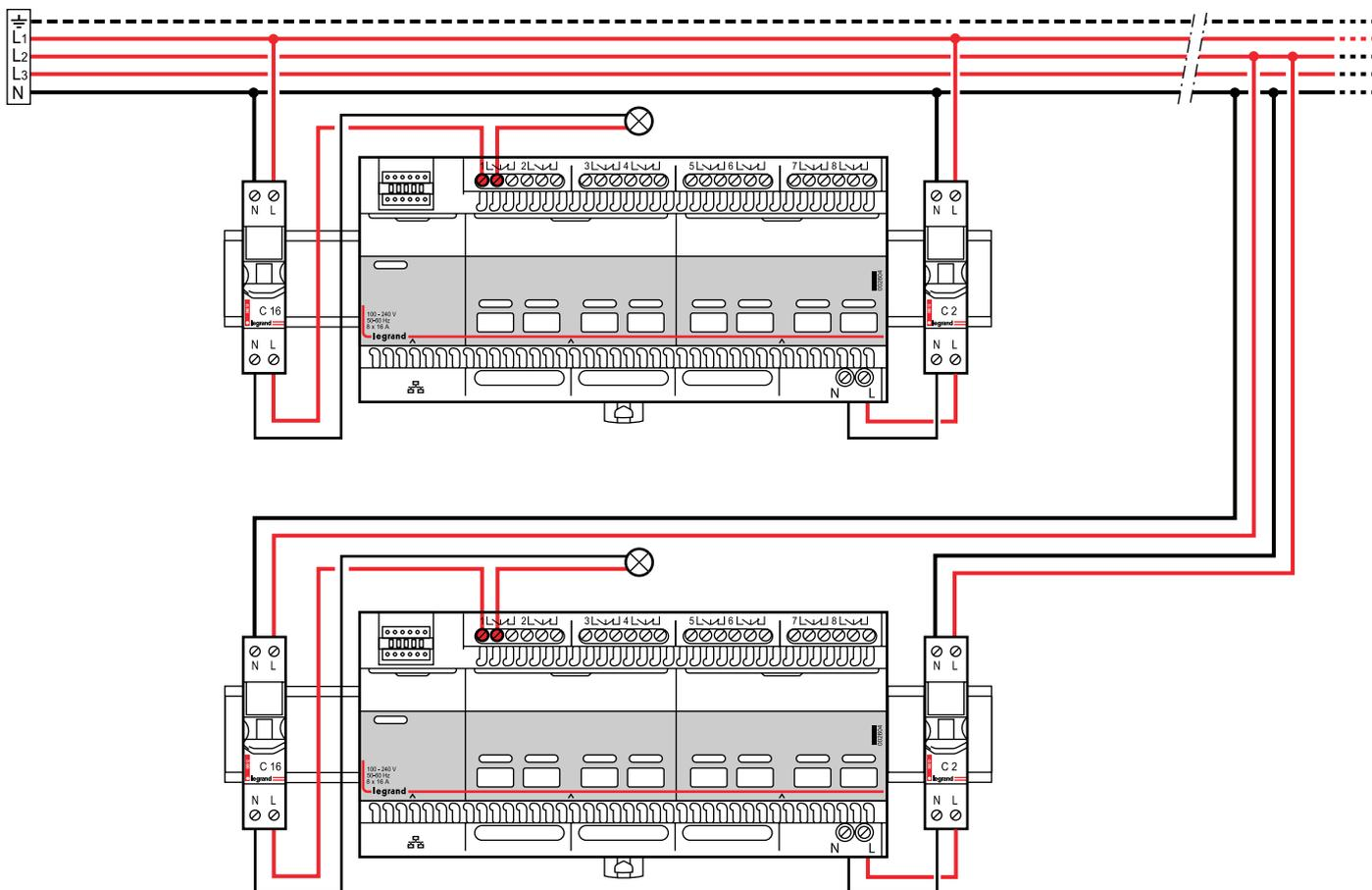
**IMPORTANT** : Ce produit doit être utilisé sur une seule phase pour respecter la coupure au zéro secteur. Les contacts de sorties utilisent la même phase d'alimentation.
