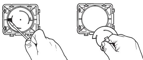
Selon les gammes d'appareillages posées, il est conseillé d'utiliser le couvercle 819 71 dans le sens qui convient :
