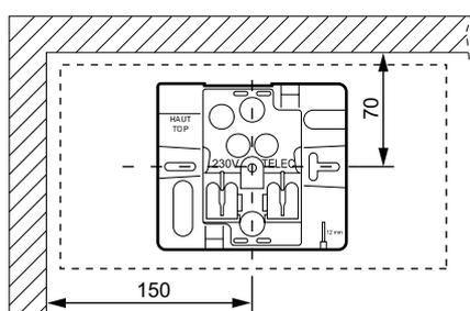
TELEC - Bornes de télécommande : pas de sens de raccordement avec les télécommandes Legrand.
