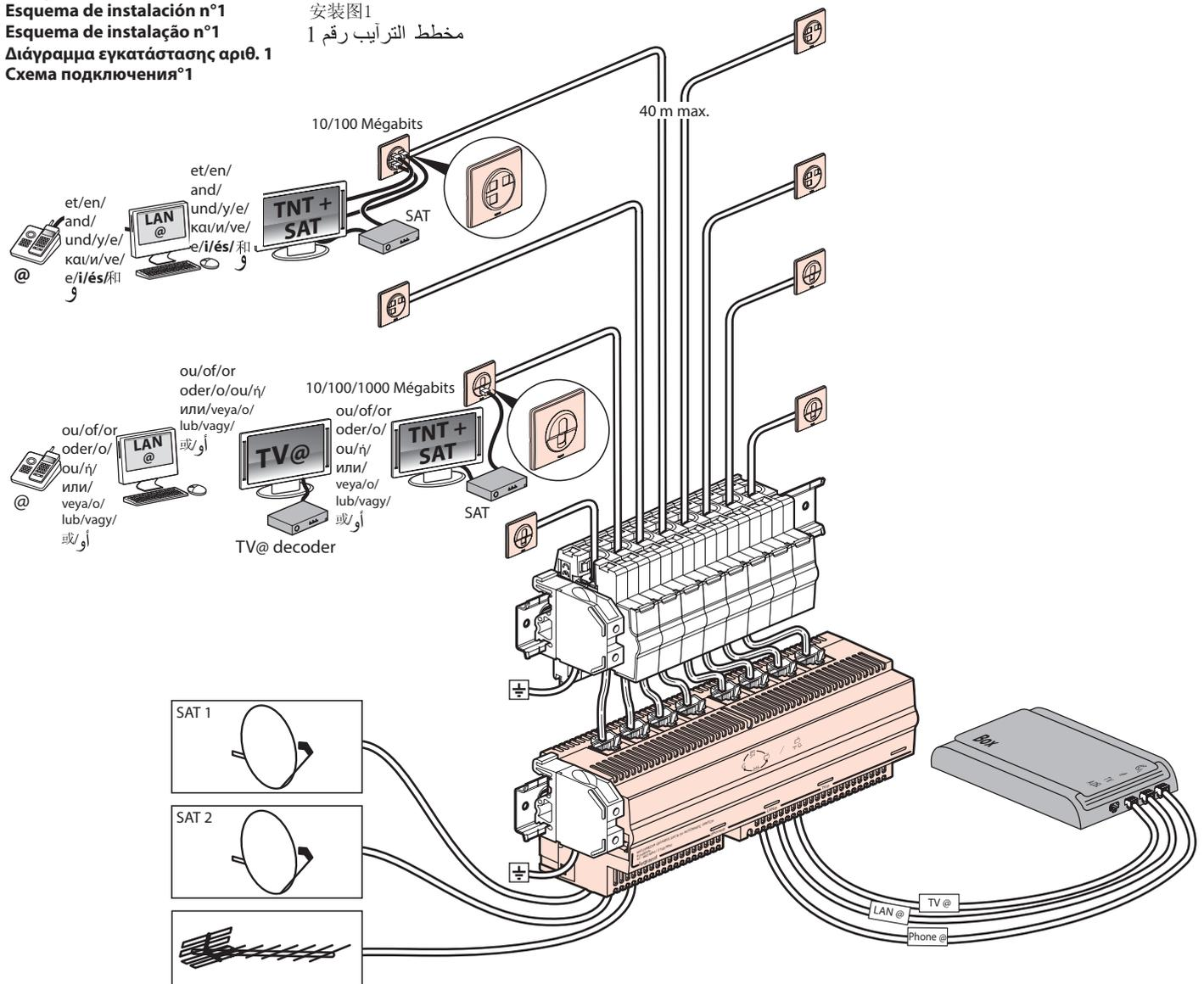
Votre "box" ne permet peut-être pas d'avoir sur la même prise murale RJ 45 le réseau informatique ou le décodeur TV/IP. Ci-dessous un moyen simple de le vérifier en connectant votre décodeur TV à la sortie LAN Ethernet de votre box.
