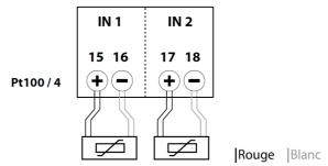
Note: la partie métallique du capteur doit être relié à la terre.
