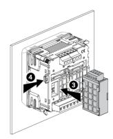
**Note: Note:** es modules doivent être connectés avec le dispositif 4 120 53 non alimenté.
