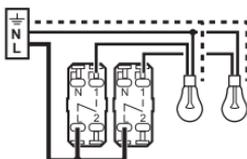
En double va-et-vient, commande de 2 endroits différents
