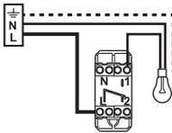
En va-et-vient, commande de 2 endroits différents
