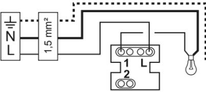
En va-et-vient, commande de 2 endroits différents.
