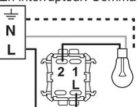
En va-et-vient. Commande de 2 endroits différents.
