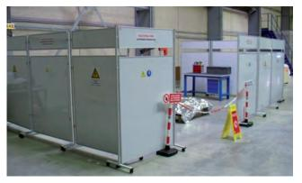
Panneaux facilement déplaçables et modulables entre eux de par une structure sur roulettes et des attaches articulées.
