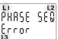
La séquence de câblage (L1-L2-L3) est erronée. Les icônes L1, L2 et L3 clignotent. Inverser les fils de tension de 2 phases (phase 1 < phase 2 ou phase 2 < phase 3). Sinon, en appuyant sur le bouton "OK" pendant au moins 5 secondes, le message disparaît jusqu'au prochain redémarrage.
