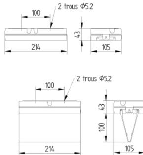
Bloc autonome d'évacuation 45 lumens. Tests automatique (SATI). Utilisation possible en mode ADRESSABLE avec supervision (protocoles ADR et CGLine+).
