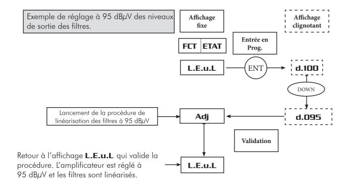
Dans le cas où le niveau d'entrée est insuffisant pour atteindre le niveau de sortie souhaité (100 dB $\mu$ V demandé en sortie mais 55 dB en entrée), le gain maximum de la centrale étant de 40 dB, le niveau de 100 dB $\mu$ V ne pourra être atteint (55 + 40 = 95), l'afficheur vous indiquera **F1Lo** qui veut dire que le niveau du filtre N°1 est insuffisant. Pour continuer la procédure , appuyer sur **ENT**. Pour continuer la procédure , appuyer sur **ENT** jusqu'à **L.E.u.L.**
