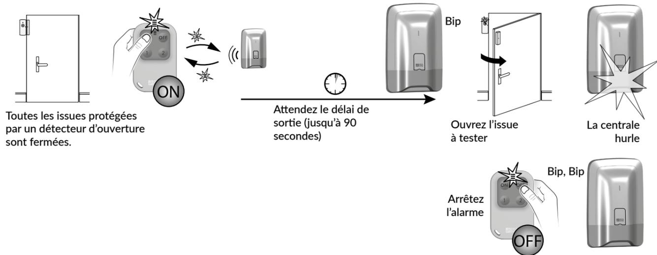
A chaque mise en marche ou arrêt du système, la centrale émet une série de bips, indiquant qu'un événement (ici la détection d'ouverture) s'est produit.
