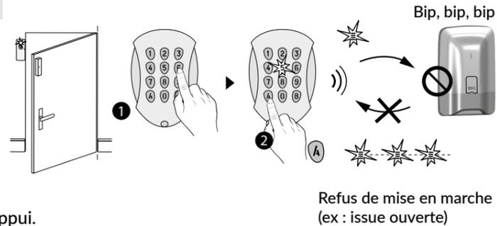
❷ Composez une 2<sup>e</sup> fois votre code d'accès suivi d'un appui sur **A** (ON) dans les 5 secondes qui suivent le 1er appui. Le voyant s'allume rouge puis vert pour valider l'action. La centrale émet un BIP.
