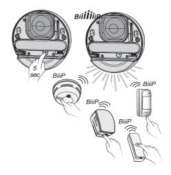
**IMPORTANT:** vous pouvez déclarer des détecteurs sur la sirène sans avoir besoin de centrale d'alarme (exemple: création d'une solution anti-incendie, avec un détecteur de fumée et une télécommande couplés sur la sirène).
