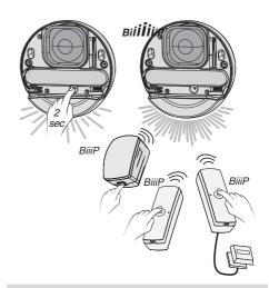
**IMPORTANT**: la sirène peut enregistrer jusqu'à **8 associations** en fonction "préalarme" **et 8 autres** en fonction "carillon".
