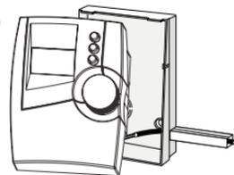
**Lors de la première mise sous tension, l'affichage n'apparaît qu'après 30 sec. environ (délai de charge du condensateur de sauvegarde), seul un sablier clignote pendant ce temps.**
