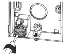
**Dans le cas d'un montage en saillie,** le cordon (2 fils, classe 2), doit arriver dans l'appareil via une goulotte.
