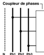
Dans le cas d'une installation en triphasé, vous devez utiliser un coupleur de phases (réf : 6051046) pour émettre sur les 3 phases simultanément.
