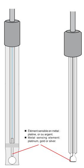
Électrode ORP séparée et électrode d'argentimétrie séparée Separate ORP electrode and separate argentometry electrode
