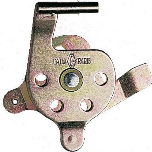
Dispositif permettant de condamner un organe de manœuvre au moyen de un à quatre cadenas dont les clés sont détenues par autant de personnes différentes partageant la responsabilité du travail à exécuter. La remise en service ne peut donc se faire que lorsque tous les intéressés ont déverrouillé leur cadenas respectif
