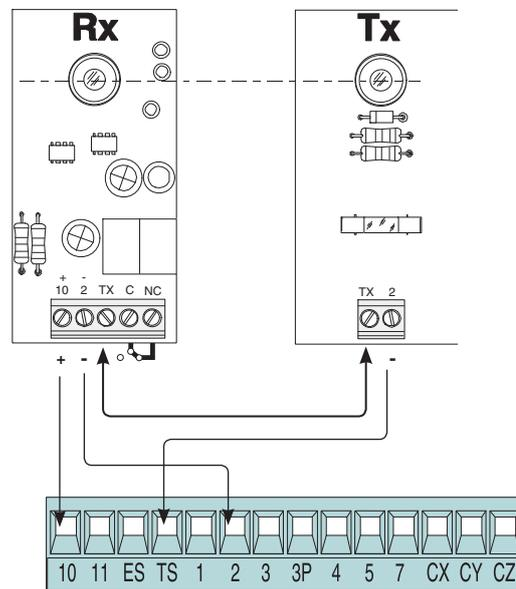
A chaque commande d'ouverture ou de fermeture, la carte contrôle le fonctionnement des photocellules. Une anomalie éventuelle détectée sur les photocellules est signalée par le clignotement de la Led sur la carte électronique et elle annule toute commande de l'émetteur radio ou du bouton.
