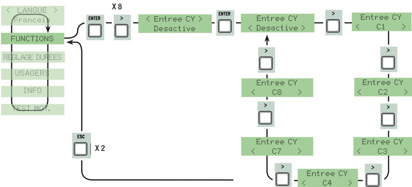
**Entrée CZ:** entrée contact de sécurité N.C. avec possibilité d'associer les fonctions suivantes : C1 (réouverture en phase de fermeture), C2 (ré-enclenchement de la fermeture en phase d'ouverture) C3 (stop partiel), C4 (attente obstacle), C7 (ré-ouverture en phase de fermeture, pour bords sensibles), C8 (ré-enclenchement de la fermeture en phase d'ouverture, pour bords sensibles) ou de le mettre hors service, voir dispositifs de sécurité sur connexions électriques.
