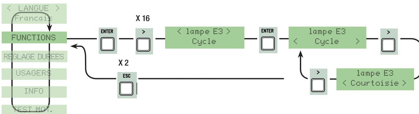
**Sortie B1-B2:** configuration sur le contact B1-B2 en modalité MONOSTABLE ou BISTABLE (interrupteur).
