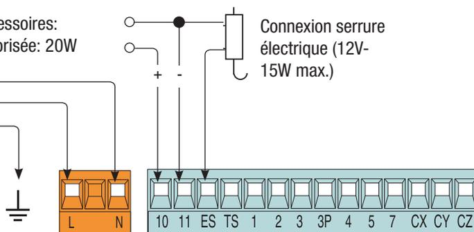
Sortie éventuelle du deuxième canal du récepteur radio (contact N.O.). Portée contact: 1A-24V (d.c.).
