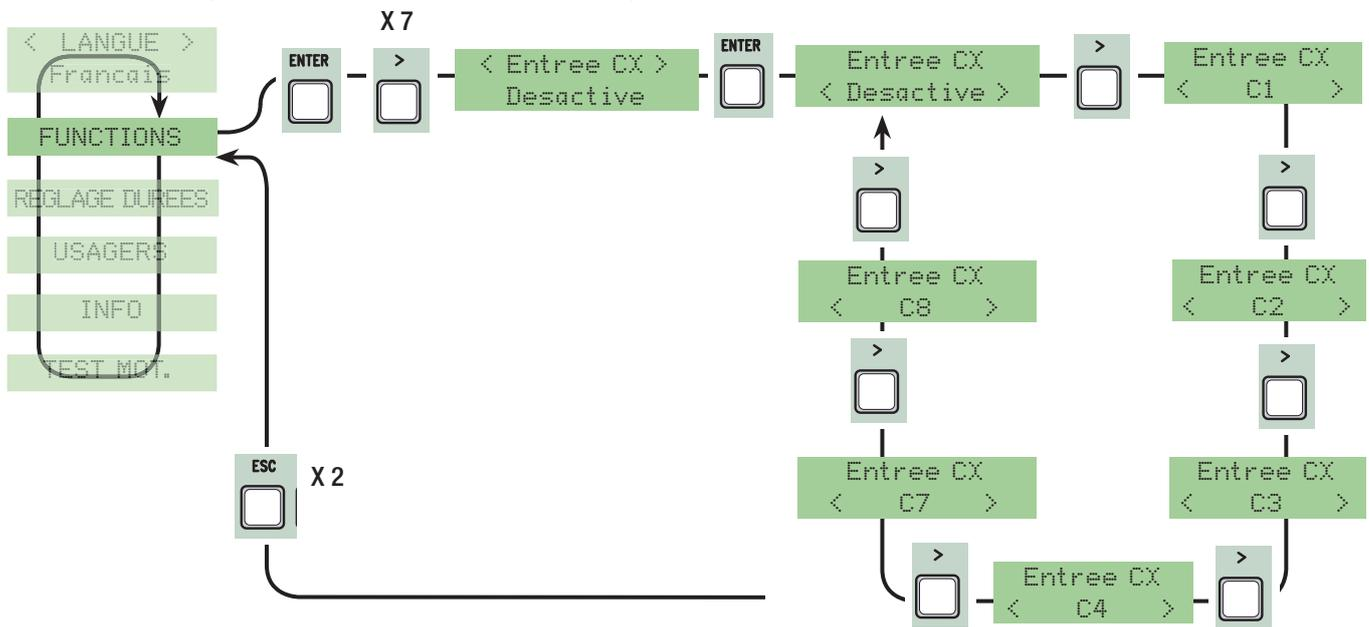
**Entrée CY:** entrée contact de sécurité N.C. avec possibilité d'associer les fonctions suivantes : C1 (réouverture en phase de fermeture), C2 (ré-enclenchement de la fermeture en phase d'ouverture) C3 (stop partiel), C4 (attente obstacle), C7 (ré-ouverture en phase de fermeture, pour bords sensibles), C8 (ré-enclenchement de la fermeture en phase d'ouverture, pour bords sensibles) ou de le mettre hors service, voir dispositifs de sécurité sur connexions électriques.
