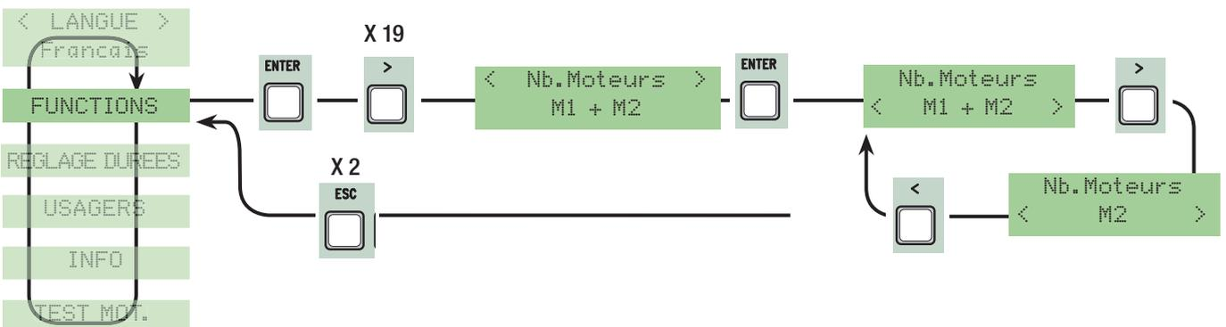
**Type moteur:** configuration du type de motoréducteur battant présent sur l'installation.
