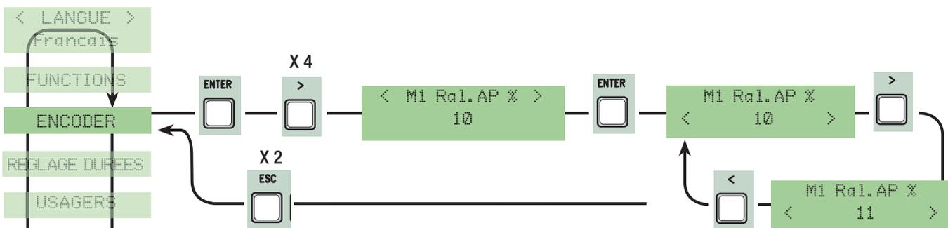
**M1 ralentissement fermeture en %:** il règle le point de départ du ralentissement du premier moteur (M1) avant le fin de course de fermeture.
