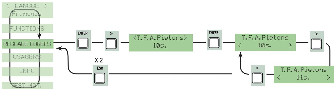
**Durée du service:** durée de fonctionnement du moteur dans la phase d'ouverture ou de fermeture de 10" à 150".
