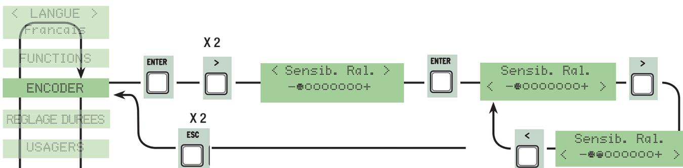
**Ralentissement Encodeur:** il active les points de départ du ralentissement en ouverture et en fermeture.
