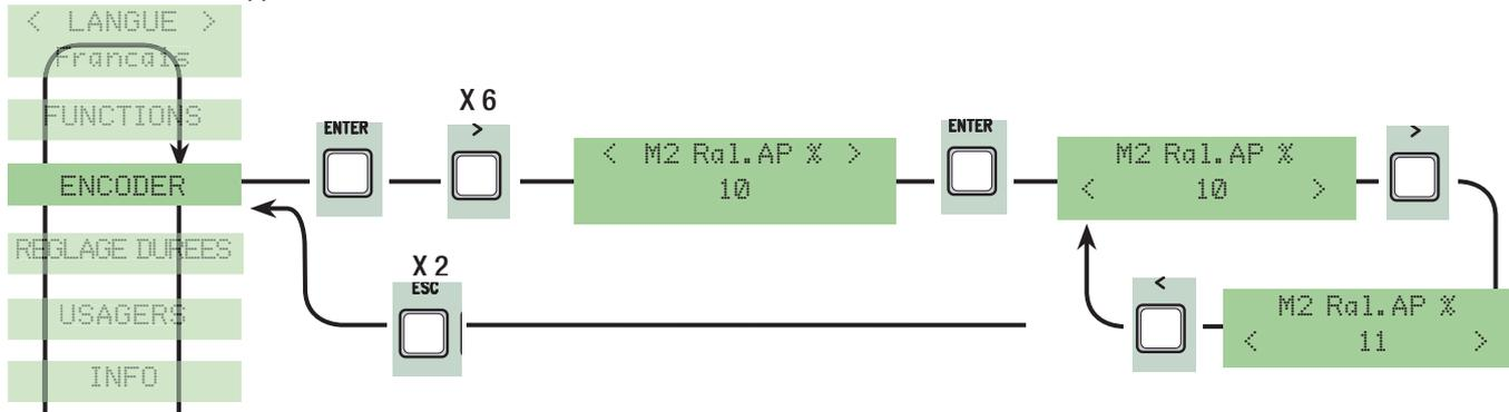
**M2 ralentissement fermeture en %:** il règle le point de départ du ralentissement du deuxième moteur (M2) avant le fin de course de fermeture.
