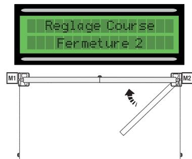
5) successivement le vantail du deuxième moteur, effectuera une manœuvre d'ouverture jusqu'à la butée d'arrêt....
