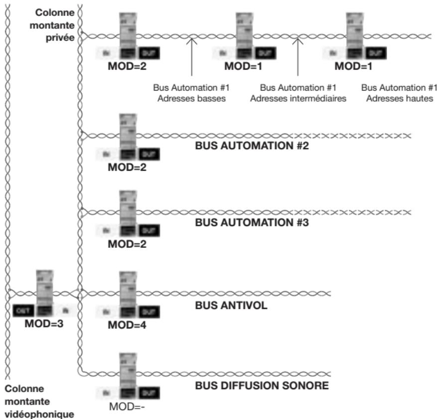
2. Sur les installations sans extension logique, mais avec extension physique, les interfaces vers Antivol, Diffusion sonore et Vidéophonie doivent être raccordées sur le bus avec les adresses les plus basses.
