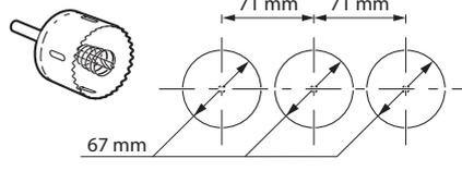
Pour repérer facilement les emplacements à percer, utiliser le gabarit de perçage réf. Legrand 0 905 40.
