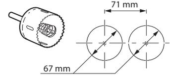
Pour repérer facilement les emplacements à percer, utiliser le gabarit de perçage réf. Legrand 0 905 40.
