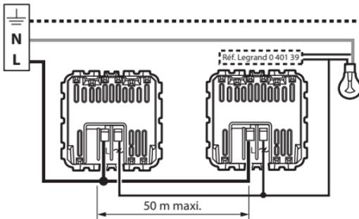
Avec 2 détecteurs, puissance de lampe 9 W mini.
