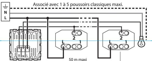
Fonction télérupteur comprise, à ne pas utiliser avec un télérupteur au tableau électrique.
