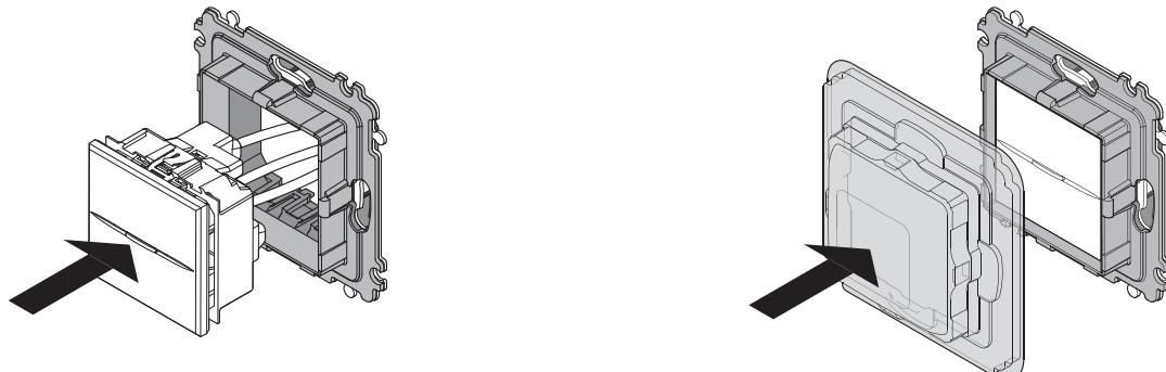
**Die Vorrichtungen installieren ohne die orangefarbene Rahmenabdeckung abzunehmen. Die durchsichtige Verkleidung anbringen.**
