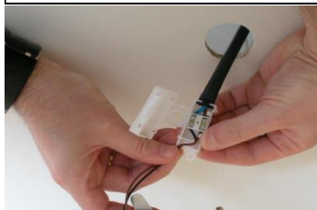
Raccorder, repositionner le manchon et fermer le boîtier.
