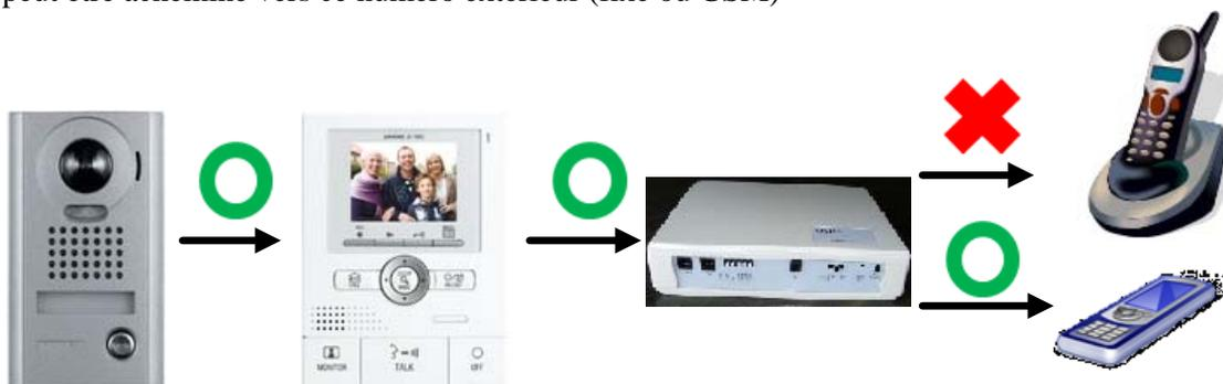
Se présentant sous la forme d'un boîtier ABS de dimensions 240 x 180 x 55 (h) mm, ce dispositif est connecté à la ligne téléphonique analogique et au système JK.
