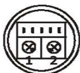
Potentiomètre VR1 : Distance de réaction : 3 à 12cm ( Conseillé 3cm )
