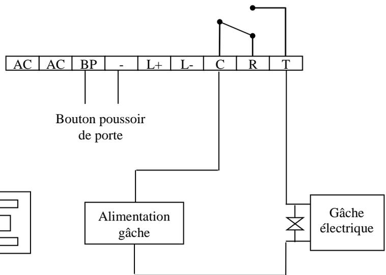
Au repos, la ventouse est alimentée et la porte est verrouillée. Lorsque le relais est actionné par la centrale, la ventouse libère la porte (appui sur bouton poussoir ou passage d'un badge autorisé).
