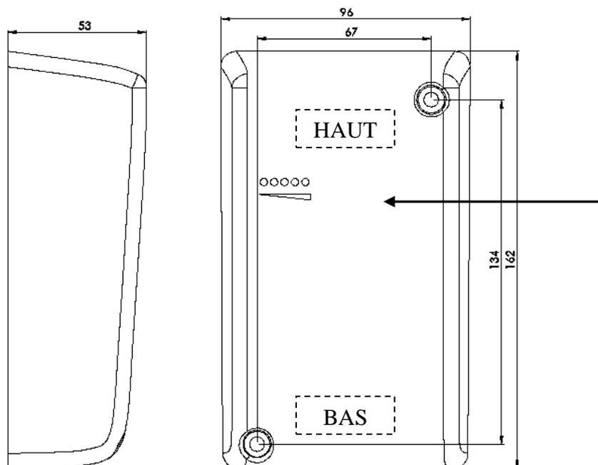
Les leds du bloc GPRS indiquent la qualité de réception du réseau GPRS environnant l'installation :
