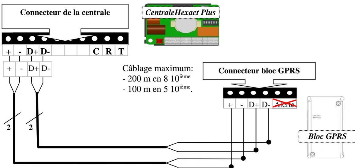
**Attention : Les bornes « Alertes » du bloc GPRS ne sont pas fonctionnelles si vous branchez le bloc GPRS sur une centrale.**
