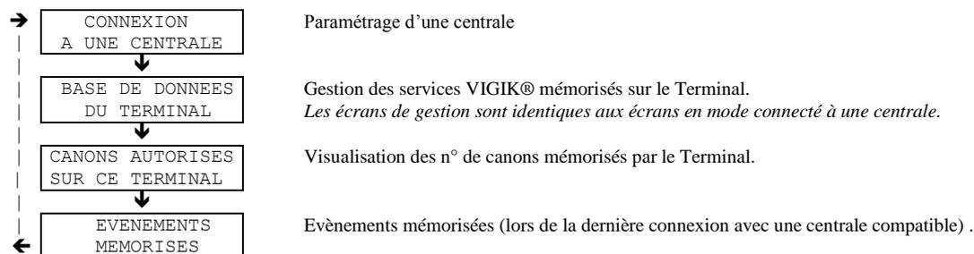
Les flèches indiquent le sens de parcours des écrans en utilisant la touche 'suivant'. La touche 'annulation' permet de sortir.
