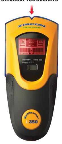
Le MultiScanner® L350 OneStep™ localise de façon aisée et rapide le centre et les bords de montants en bois ou solives en métal derrière les murs, plafonds et planchers jusqu'à une profondeur de 76 mm. Un inverseur à 3 positions permet un changement de mode aisé, tandis que l'afficheur rétroéclairé ultra-brillant, le pointeur SpotLite® et un signal sonore indiquent tous la position de la cible. L'indicateur de Puissance du Signal permet de distinguer entre des cibles profondes ou non.
