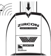
En cas d'objets plus profonds (murs plus épais), seulement deux barres s'afficheront sur l'Indicateur de Force du Signal et seuls le Pointeur SpotLite®, l'indication CENTER et quelques segments du milieu de l'Indicateur de Cible s'allumeront. Si vous ne pouvez toujours pas situer d'objet, essayez le chapitre suivant.
