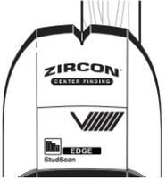
Fahren Sie entlang der Oberfläche mit dem Scannen fort. Wenn die Balkenmitte mit den drei Säulen auf dem Signalstärkenanzeiger ermittelt wurde, leuchten einige Segmente der Zielanzeigesäulen, die MITTE-Anzeige sowie der SpotLite®-Zeiger auf, und es ertönt ein Signalton.
