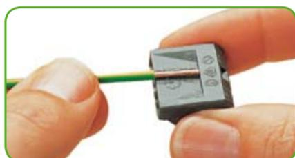
La longueur de dénudage est de 10 à 13 mm. La mesure peut être faite grâce à la toise intégrée à la borne.
