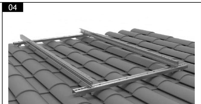
M8×20mm hexagonal ×4 // M8 écrou ×4 // M10 rondelle ×8
