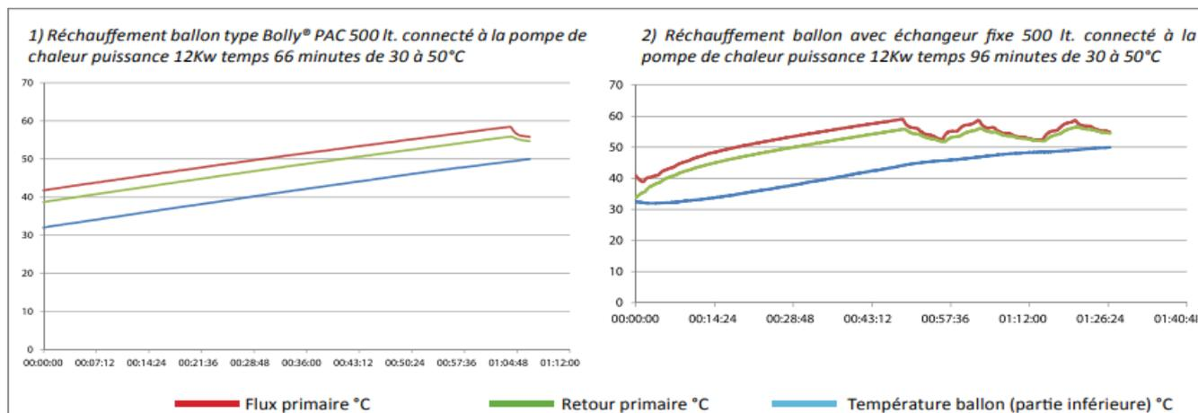
30% de réduction du temps de montée en température et meilleur confort d'utilisation de la P.A.C en chauffage et refroidissement.
