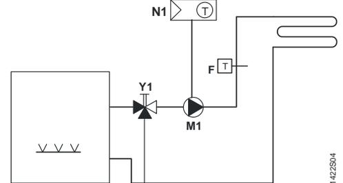
Thermostat d'ambiance avec régulation directe d'un système hydraulique de chauffage par le sol.
