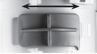
In sommige (zeldzame) gevallen, voor een doeltreffende reiniging, dient de hoeveelheid residuwater (hoeveelheid overblijvend water na een grote spoeling) verhoogd te worden. Verplaats hiervoor de afsluiter (d) naar links (hoe meer de afsluiter open is hoe groter de hoeveelheid residuwater).
