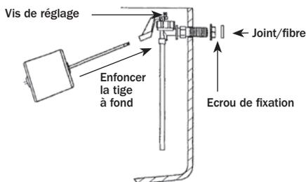
Visser à la main l'écrou du robinet jusqu'au contact de la céramique. Si nécessaire visser d'un quart de tour supplémentaire (maxi) à l'aide de la clé spécifique.
