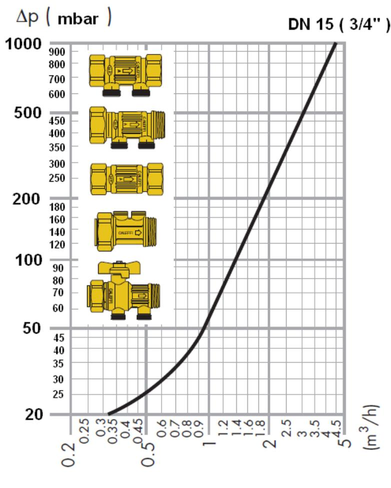
**VANNE A SPHERE AVEC CLAPET ANTIPOLLUTION INTEGRE SCUDOBALL**
