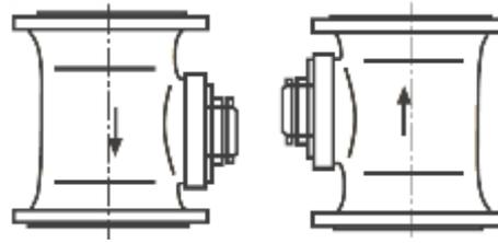
**\* : Dans les positions verticales, il est impératif que la tuyauterie soit constamment en eau.**
