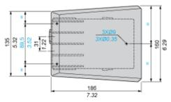
(1) 2 entrées taraudées pour presse-étoupe n° 16 (Pg 16). Pour ISO M20, utiliser un adaptateur DE9RA620.
