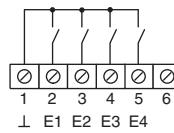
Entradas binárias E1...E4: Ligar contactos das janelas, interruptores de abertura ou fecho na régua de terminais entre os terminais 1 e 2...5.
