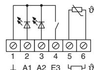
Sorties binaires A1, A2 : Raccorder LED ou relais électronique à la borne plate entre bornes 1 et 2...3.
