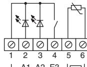
Saídas binárias A1, A2: Ligar LED ou relés electrónicos à régua de terminais entre os terminais 1 e 2...3.
