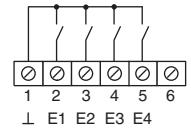
Entrées binaires E1...E4 : Raccorder les contacts de fenêtres, les poussoirs de fermeture ou d'ouverture à la borne plate entre les bornes 1 et 2...5.
