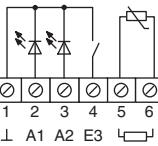
Salidas binarias A1, A2: conecte el diodo LED o los relés electrónicos en la regleta de bornes, entre los bornes 1 y 2...3. Conecte el sensor de temperatura entre los bornes 5 y 6.
