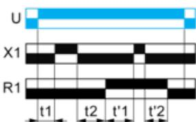
$$T = t_1 + t_2 + \dots$$
