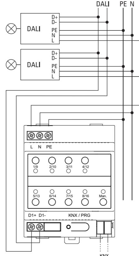
Assim que todas as ligações estiverem concluídas e a tensão de alimentação tiver sido conectada, a linha DALI pode ser colocada em funcionamento e a programação pode ser realizada com ETS.
