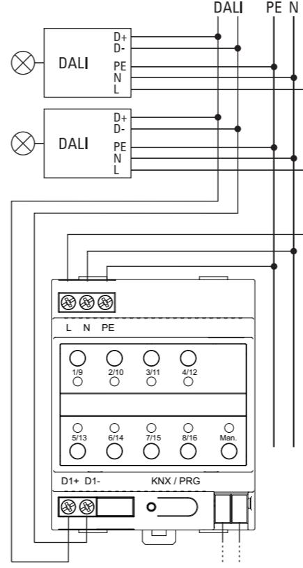
Tras completar todas las conexiones y conectar el suministro de energía, la línea DALI puede ponerse en servicio y la programación puede realizarse con el ETS.
