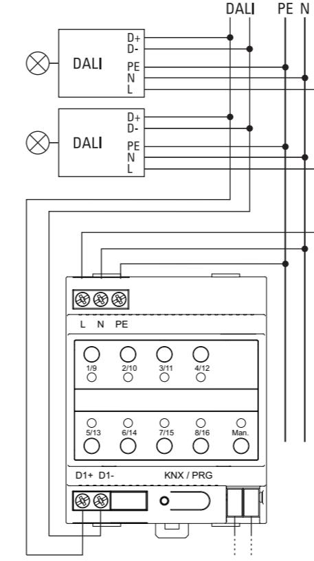
Une fois que tous les raccordements sont effectués et que la tension d'alimentation est mise, vous pouvez mettre en service la ligne DALI et réaliser la programmation avec l'ETS.
