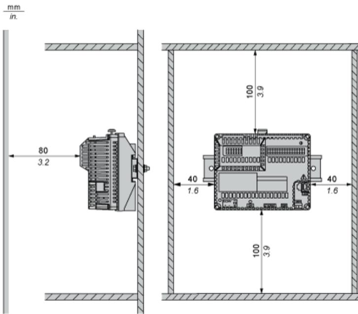
Ménagez un espace adéquat en vue d'assurer une ventilation permettant de maintenir une température ambiante de 0 à 50 °C (32...122 °F) pour une installation horizontale et de 0 à 40 °C (32 à 104 °F) pour une installation verticale.
