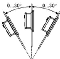
Lorsque le produit est installé dans une position ayant une inclinaison dépassant 30°, la température ambiante ne doit pas dépasser 40 °C (104 °F). Vous pouvez utiliser un dispositif de refroidissement de l'air (ventilateur, climatiseur) pour vous assurer que la température de fonctionnement ne dépasse pas 40 °C (104 °F).
